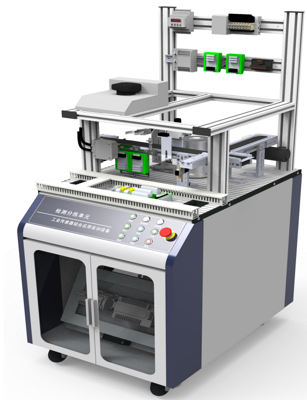
图13 传感器在线质量检测应用单元
