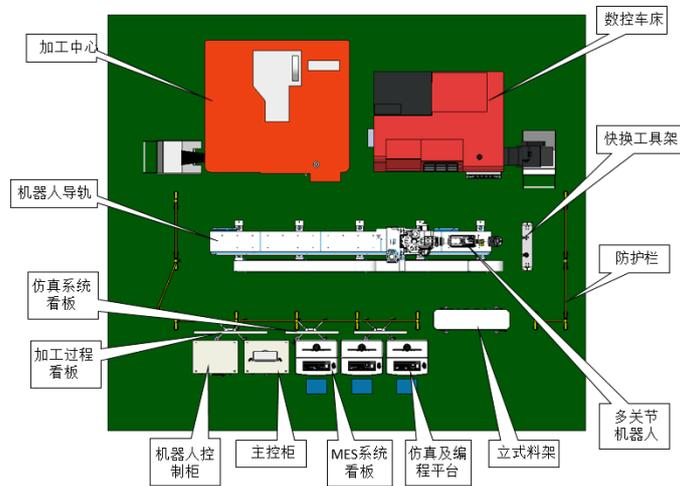
图 2 切削加工智能制造单元技术平台俯视图
