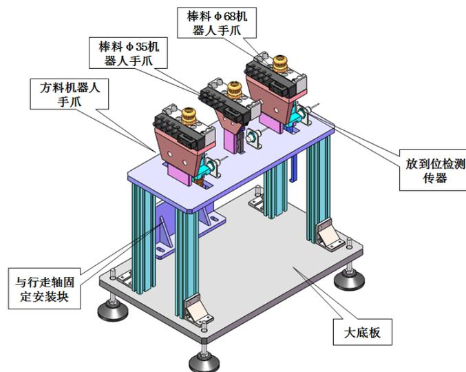
图 7 机器人快换夹具工作台示意图
