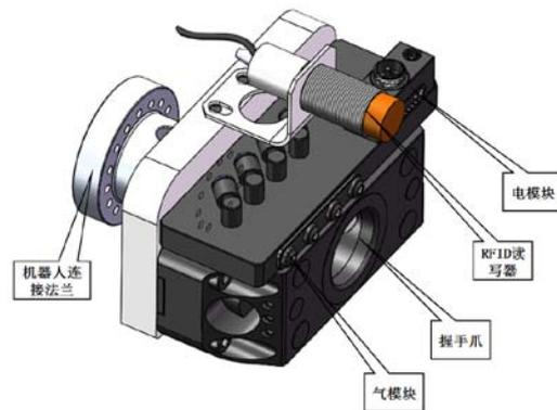
图 3 机器人快换手爪机器人侧示意图
