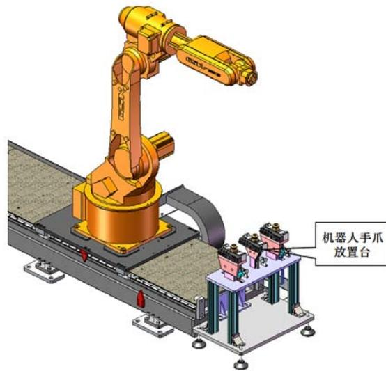
图 6 机器人快换夹具工作台位置示意图
